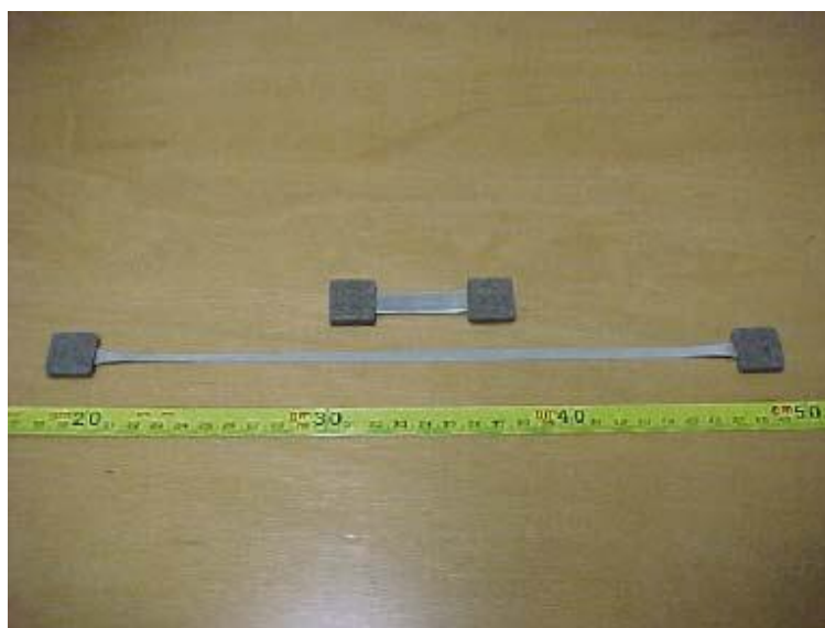
Figura 2.6. Alongamento de 650% em um ensaio de PbSn60 em condições superplásticas (Franchitti, 2007, p.4)
