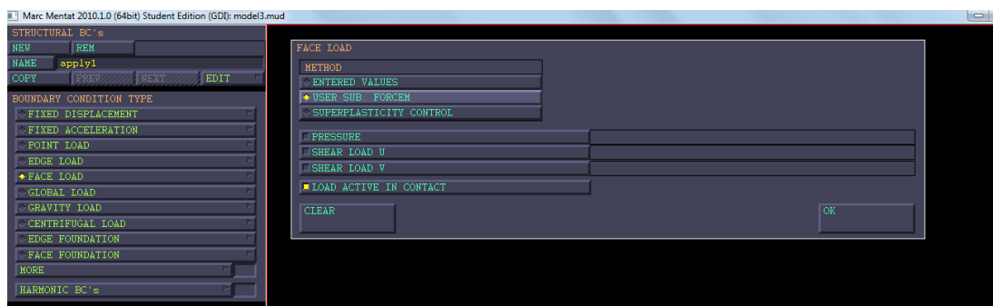
Figura 3.10. Ilustração da configuração necessária para usar uma sub-rotina que implementa uma condição de carregamento
