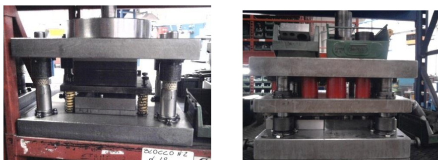
Figura 3.2. Modelos de estampo usados na Panzeri S.p.a
