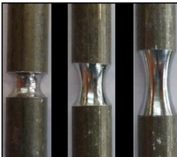
Figura 2.3. Barras entalhadas usadas nos ensaios de tração (Simionato, 2010)
